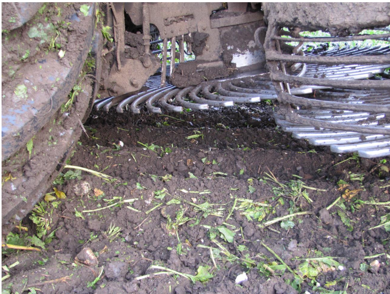
Foto 9: Sklízeč cukrovky Holmer Terra Dos T4, čistící paprsková kola
