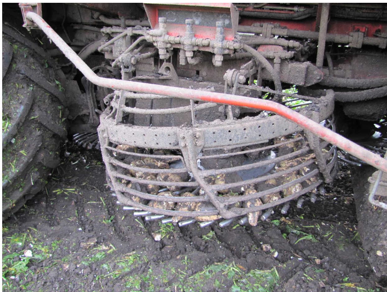
Foto 5: Sklízeč cukrovky Holmer Terra Dos T2, čistící paprsková kola
