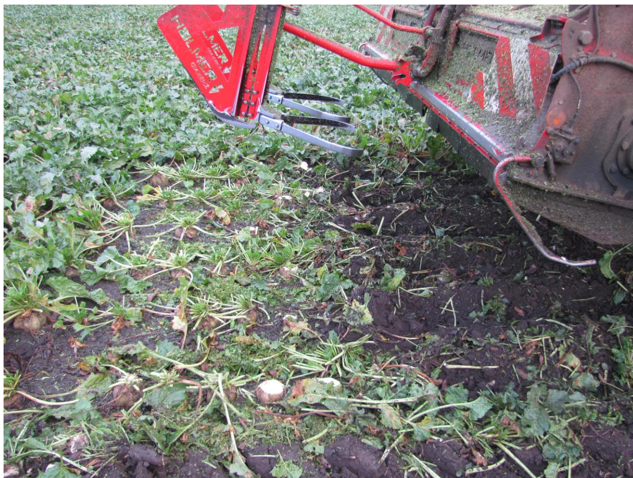
Foto 20: Ořez bulev sklízěčem Holmer Terra Dos T4
