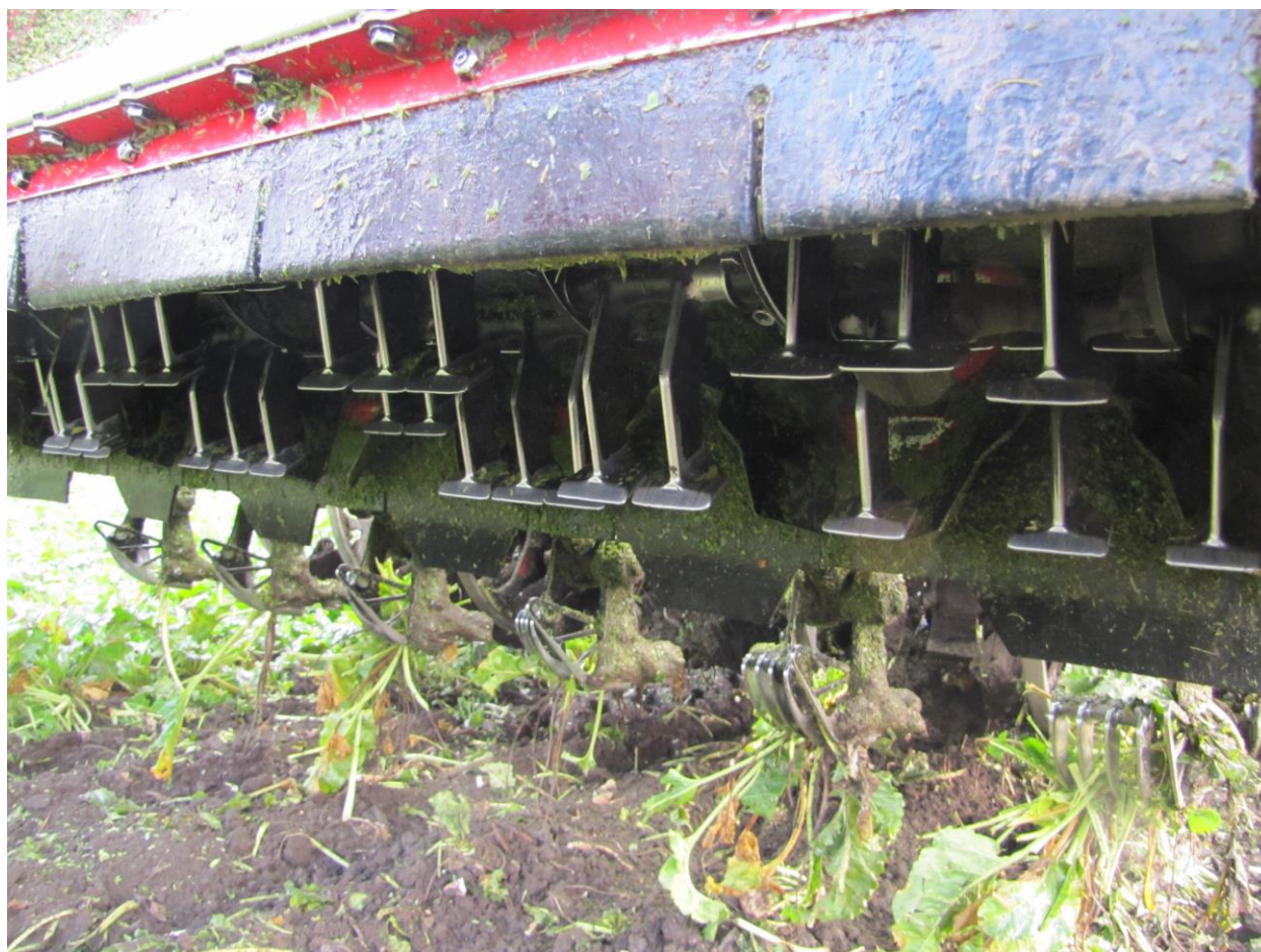
Foto 11: Sklízeč cukrovky Holmer Terra Dos T4, ořezávač chrástu
